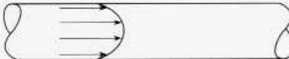
Зависимость профиля потока крови от диаметра сосуда. Профиль потока крови более плоский, когда кровь течет через более широкий сосуд (A). Профиль становится параболическим в более узком сосуде (B).
